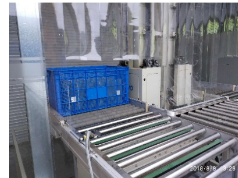
4. 启动设备，滚筒线将货物送入货物提升机
